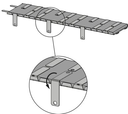
3. Pliez les plaques métalliques avec trous pré-percés à 270°.
