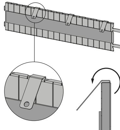
2. Pliez que les plaques métalliques avec trous pré-percés à 300 °.
