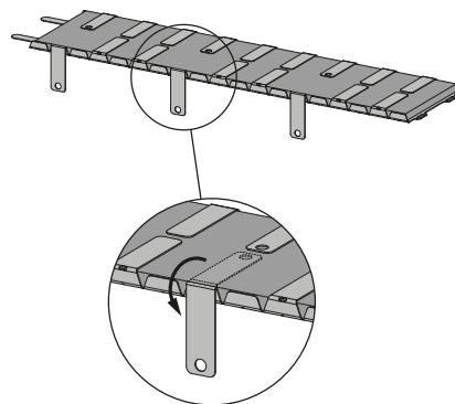
2. Pliez les plaques métalliques avec trous pré-percés à 270°.
