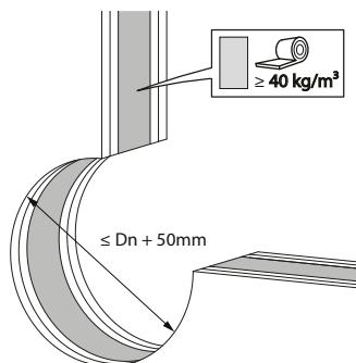
2. Prévoyez une réservation de  $\varnothing d + 27$  mm minimum et  $\varnothing d + 50$  mm maximum pour diamètres de tuyau 32-75,  $\varnothing d + 36$  mm et  $\varnothing d + 50$  mm pour diamètres de tuyau 80-110,  $\varnothing d + 40$  mm et  $\varnothing d + 50$  mm pour diamètres de tuyau 125-160.
