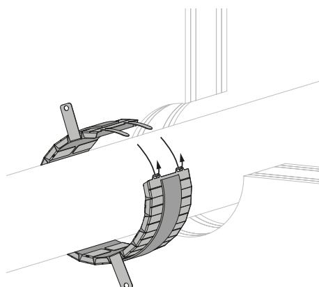
4. Pliez le manchon et montez-le autour du tuyau. Insérez les languettes de fermeture dans les réservations prévues. Repliez les languettes.
