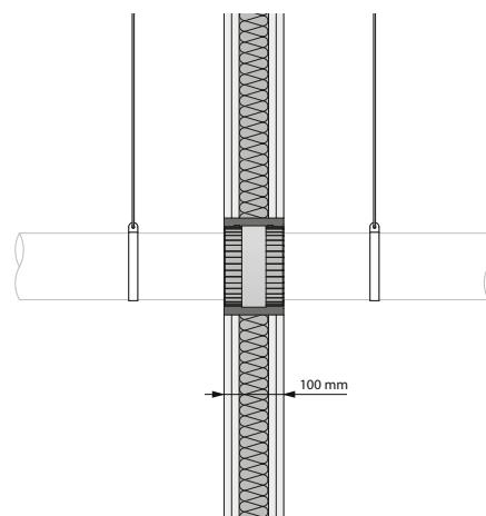
6. Attention : Cette installation n'est pas valable pour les parois flexibles d'une largeur supérieure à 100 mm (par exemple 125 ou 150 mm). Le MG-U L125/L150 est utilisé à cette fin. Veuillez contacter Rf-t pour plus d'informations.
